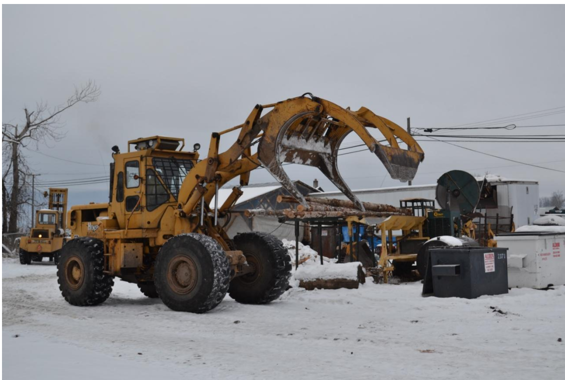
<ログ材の原木を皮むき機に入れる大型クレーン車両>
