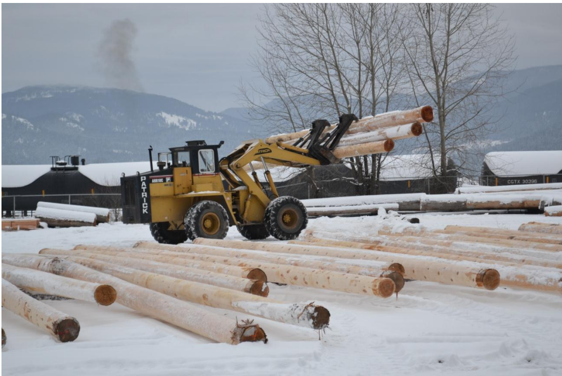
<使用されるログ材を選別する大型重機>
