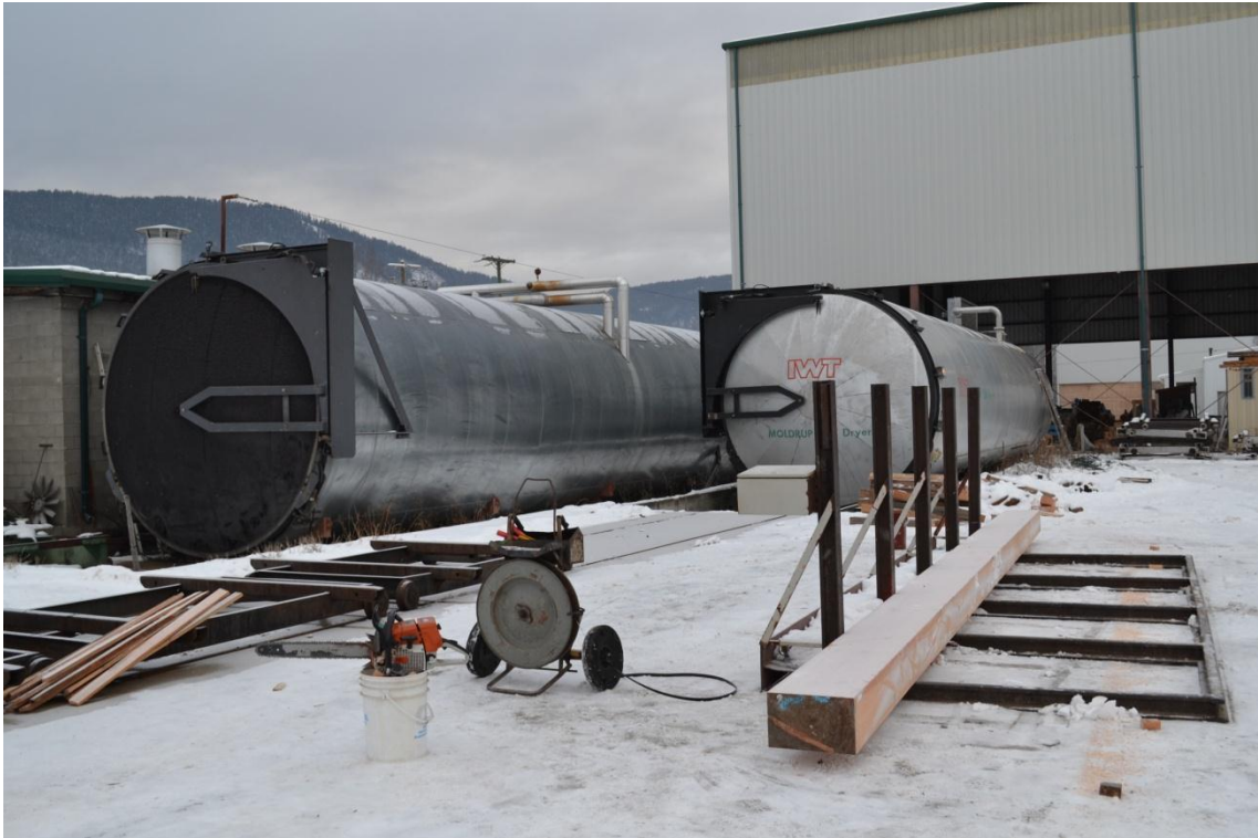
<大量のログ材を一機に乾燥させるフィンランド製乾燥機 乾燥期間1～2週間>
